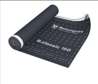
Paropropustná fólie B.classic 150 SK DUO (vhodná pouze pro suché impregnované dřevo) PP rozměr: 1,5 × 50 m spotřeba: 1 role / 75 m² balení: 1 role | 24 rolí/paleta
